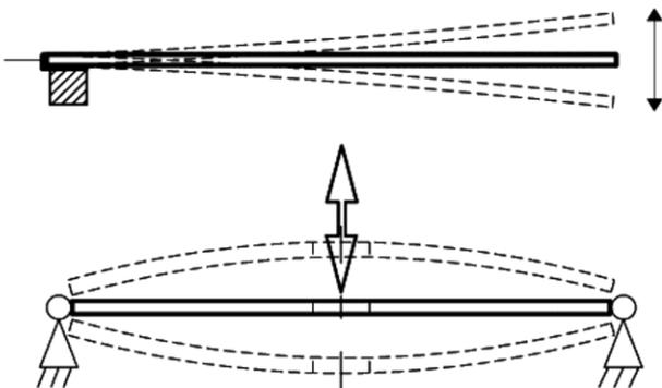
PICMA 弯曲型促动器的移位：单边（顶部）和双边（底部）夹紧。
