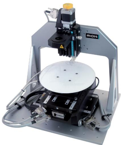
集成了线性电机轴，能实现快速XY方向高精度扫描的晶圆检测系统。步进电机轴用于检测设备纵向上的微调定位。首页：具有灵活15轴配置的双面晶圆检测系统
