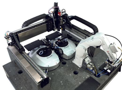
这一系统主要用于硅光子芯片上光纤的自动封装与对准，系统集成数种硬件和软件，例如用于精确定位的捡取放置机器人技术、图像处理技术和设备等
