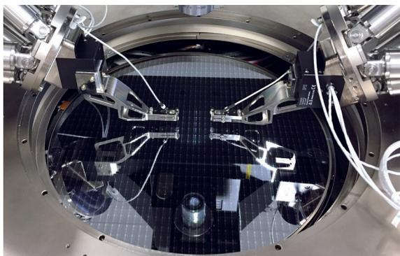
18轴双对准系统能够为晶圆检测器的硅光子设备提供快速的N×M对准。Cascade Microtech先进的Cm300xi光子工程晶圆检测站集成了PI的快速多通道光子对准系统，来实现对晶圆内硅光子设备的高处理能力、晶圆无伤、纳米级精度光学检测。（图片：Cascade Microtech，一家FormFactor公司）
