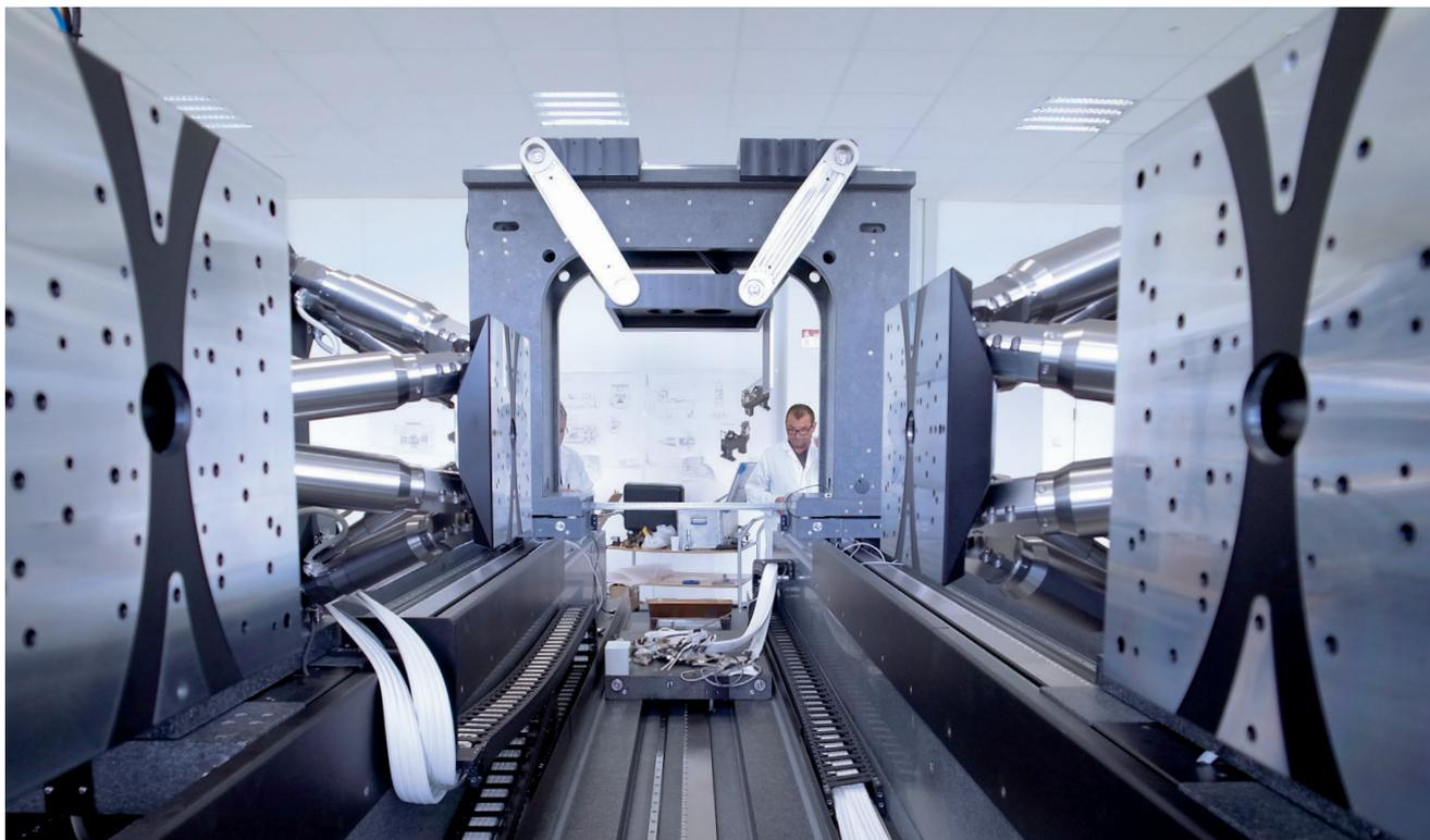
这套20吨级的56轴运动系统主要用于X-射线显微检查，以及X-射线光学产品的质量验证。这套系统配备了56台电机、16个控制器和7套空气轴承花岗岩滑块，总重量超过了20吨。能够在其整个工作范围内达到百纳米级的非凡精度。
